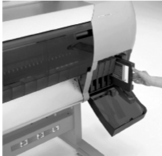
Abbildung 2.36 Ist viel zu drucken, braucht man auch viel Tinte. Dieser Drucker hat 6 Tintentanks zu 500 ml. Hier wird gerade einer ausgewechselt (Epson)
