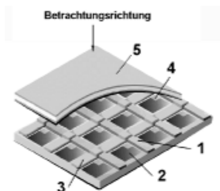
Abbildung 2.9 Aufbau eines LCD-Aktivmatrix-Bildschirms (Dell)
