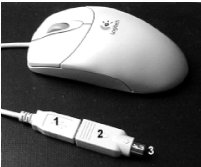
Abbildung 6.9 USB-Maus mit Vorschaltvorrichtung zum Betrieb am PS/2-Mausinterface
