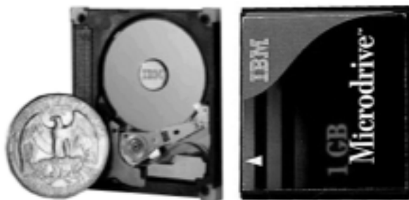
Abbildung 7.5 Eine Festplatte im CompactFlash-Formfaktor: IBM MicroDrive. Speicherkapazität 1 GBytes (nach: IBM)
