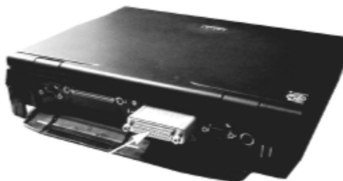
Abbildung 4.7 Dongle an der Parallelschnittstelle eines portablen PCs. Der Pfeil zeigt auf den Steckverbinder, an den das Gerätekabel angeschlossen werden kann
