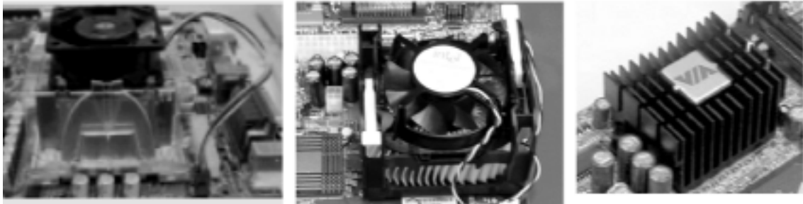
Abbildung 2.19 Ein wichtiges Ziel: möglichst keinen Lüfter (und wenn schon, dann einen ganz kleinen...). Links: Xeon und Pentium 4 mit den typischen Kühlkörper-Lüfter-Konstruktionen; rechts: VIA Eden ohne Lüfter
