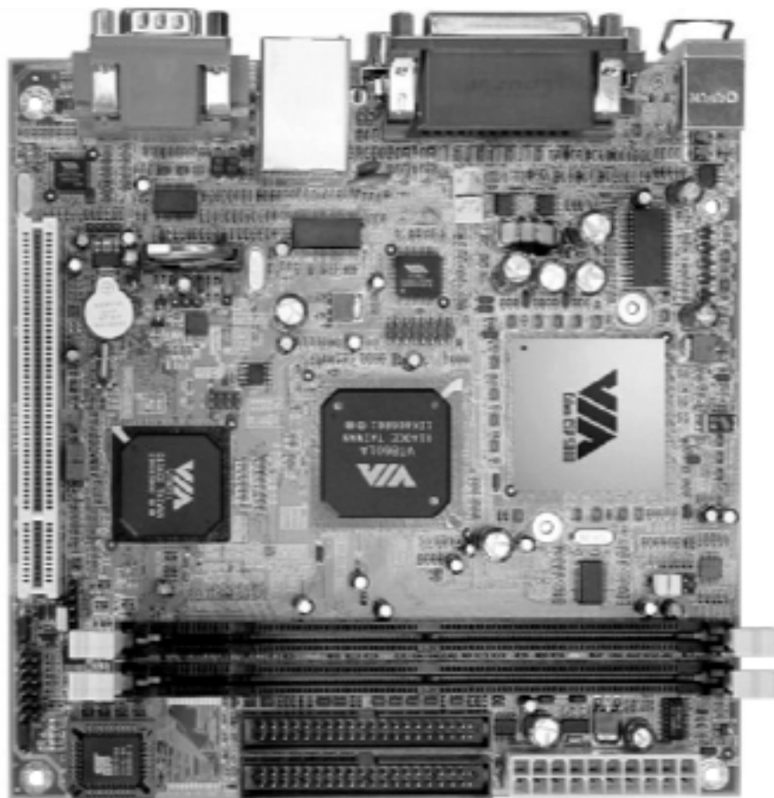
Abbildung 1.51 Ein besonders kleines Motherboard: der Formfaktor Mini-ITX (VIA Technologies)
