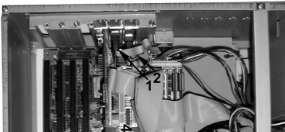
Abbildung 1.47 Interfacianschlüsse in herkömmlichen PCs. 1 - Slot-Abdeckblech mit Interface-Steckverbindern; 2 - Flachbandkabel zum Motherboard
