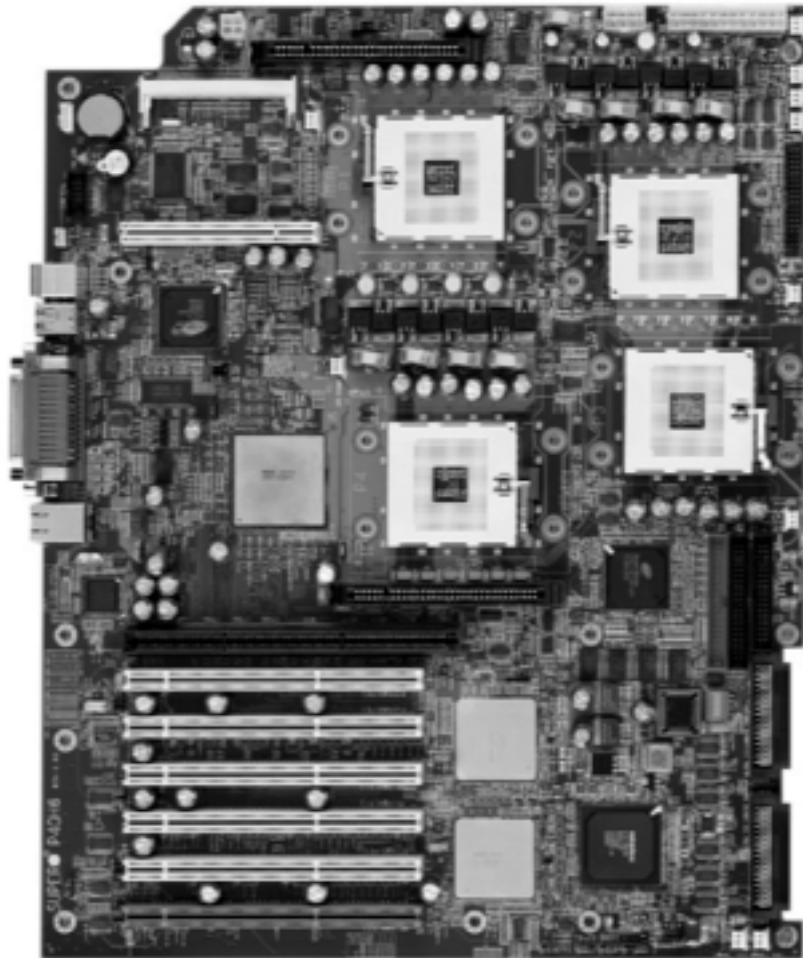
Abbildung 1.22 Server-Motherboard für maximal 4 Prozessoren (1). Ansicht (Supermicro)
