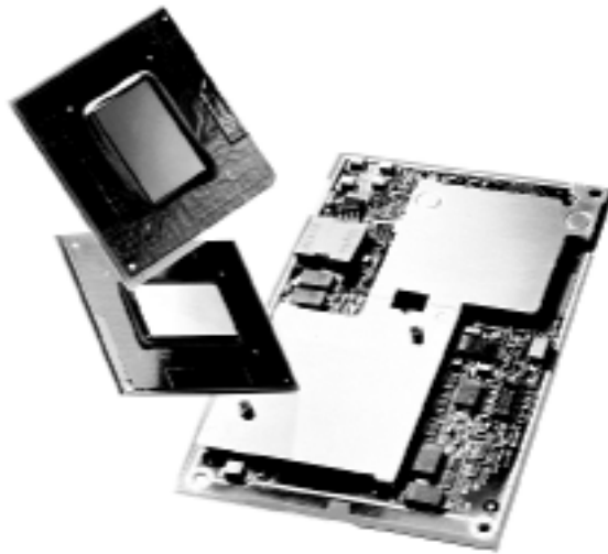
Abbildung 2.21 Prozessoren für portable Systeme in verschiedenen Bauformen: BGA, Micro-PGA, Mobile Module (Intel)
