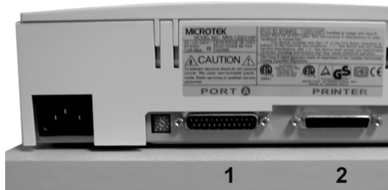
Abbildung 4.6 Gerät (hier: ein Scanner) mit zwei Steckverbindern. 1 - vom PC; 2 - zum nächsten Gerät (beispielsweise zum Drucker)
