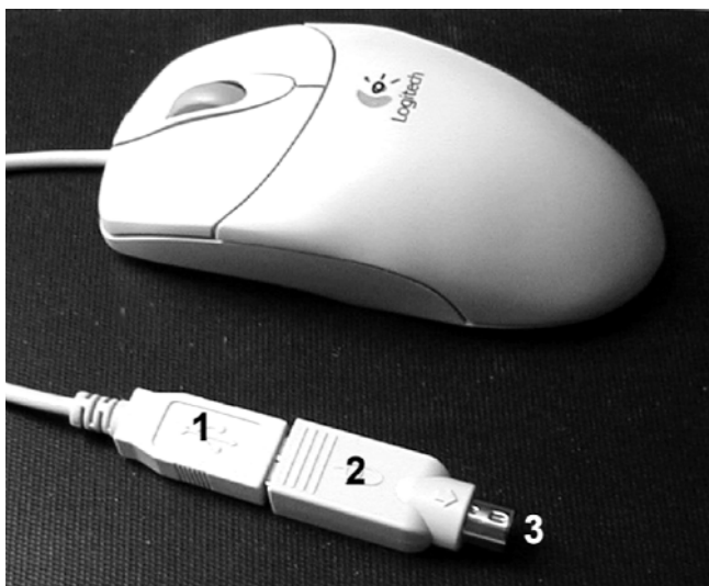
Abbildung 6.9 USB-Maus mit Vorschaltvorrichtung zum Betrieb am PS/2-Mausinterface
