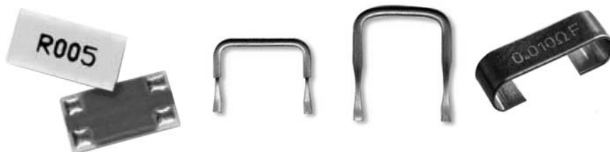
Abb. 1.20 Kostengünstige Strommeßwiderstände (nach [1.8] und [1.9]). Links ein Dickfilm-Chipwiderstand für Vierdrahtanschluß; Mitte und rechts einfache Metallwiderstände.
