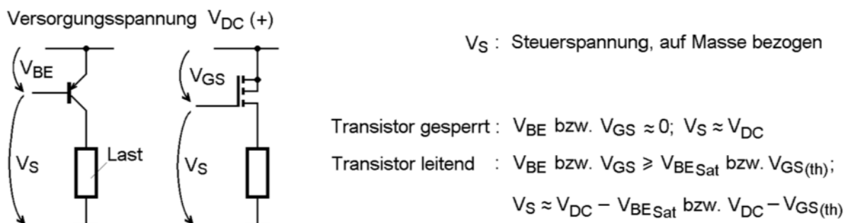
Abbildung 11.3.5 High Side Drive mit pnp- und p-Kanal-Transistoren
