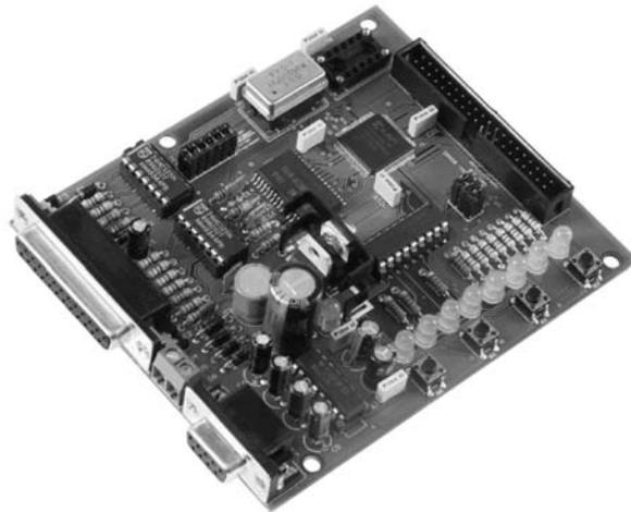
*Aufgabe 1: Zähler.* Wir haben nur einen Takt von 16 MHz. Um Taktimpulse mit niedrigeren Frequenzen abnehmen zu können, bauen wir einen 24-Bit-Binärzähler aus einem 16-Bit-Funktionsblock und einem 8-Bit-Funktionsblock. Der letztere ist mit den LEDs zu verbinden. Für die vier Tasten ist ein Pufferregister vorzusehen. Namen: LEDs LED(7:0), Tasten KEY3...KEY0. Die LEDs werden direkt angesteuert, die Tasten wirken invertiert.
