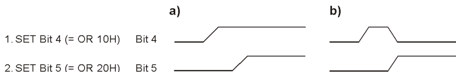
Abb. 4.5 Theorie und Praxis. a) Programmierabsicht; b) der tatsächliche Signalverlauf an den Anschlüssen
