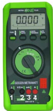
Abb. 7 Das portable Digitalmultimeter (MetraHit). 1 - Bezugspegel oder Stromeinspeisung; 2 - Spannungsmessung; 3 - Stromweg für max. 300 mA; 4 - Stromweg für max. 10 A.
