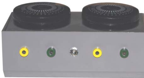
Abb. 25 Der Stellwiderstand 09 von hinten. Kippschalter oben: unabhängige Widerstände. Kippschalter unten: Spannungsteiler. Abgriff an beiden mittleren Buchsen.
