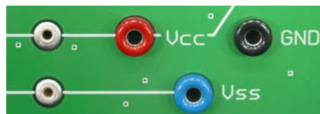
Abb. 20 Stromversorgungsanschlüsse. Analog:: VCC = + 15 V, VSS = – 15 V (Festspannungsnetzgerät).
