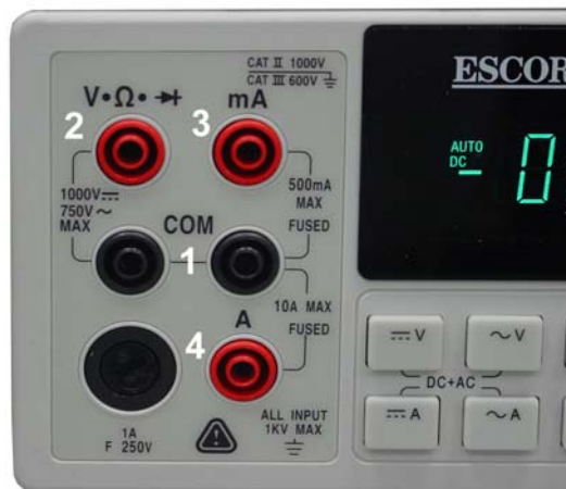
Abb. 6 Das eingebaute Digitalmultimeter (Escort). 1 - Bezugspegel (0 V) oder Stromeinspeisung; 2 - Spannungsmessung, Widerstandmessung, Bauelementprüfung; 3 - Stromweg für max. 500 mA; 4 - Stromweg für max. 10 A.
