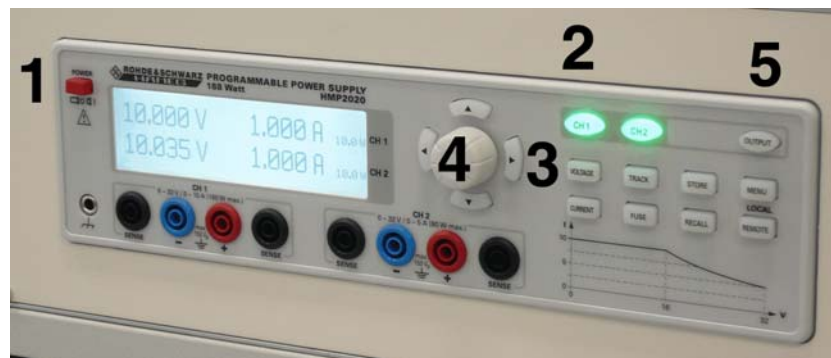
Abb. 14 Labornetzgerät Hameg HPM2020. Spannungseinstellung in folgenden Schritten: 1. Einschalten. 2 - Kanal 1 wählen. 3. Spannungseinstellung (VOLTAGE). 4. Spannungswert eindrehen. 5 - Spannung auf die Buchsen schalten (OUTPUT).
