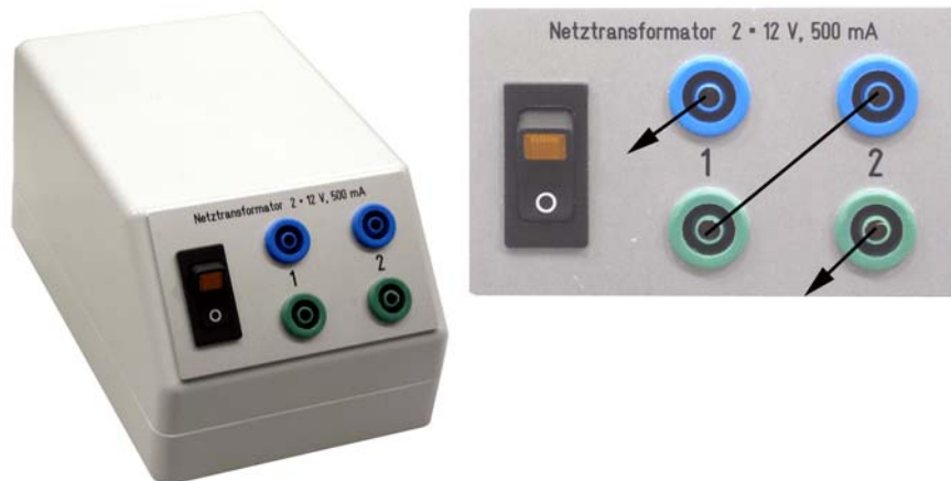
Abb. 15 Netztransformator 12. Rechts die Reihenschaltung der beiden Wicklungen.
