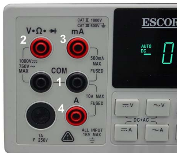
Abb. 7 Das eingebaute Digitalmultimeter (Escort). 1 - Bezugspegel oder Stromeinspeisung; 2 - Spannungsmessung, widerstandsmessung, Bauelementprüfung; 3 - Stromweg für max. 500 mA; 4 - Stromweg für max. 10 A.
