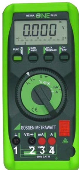
Abb. 8 Das portable Digitalmultimeter (MetraHit). 1 - Bezugspegel oder Stromeinspeisung; 2 - Spannungsmessung; 3 - Stromweg für max. 300 mA; 4 - Stromweg für max. 10 A.
