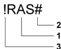
Abb. 1.30 Typische Negationsangaben. 1 - der eigentliche Signalname; 2 - Negationssymbol. Es besagt, dass das Signal aktiv (wirksam) ist, wenn es mit Null belegt ist. 3 - Negationsoperator. Weist an, die Schaltgleichung so zu implementieren, dass bei Erfüllung der Gleichung der Funktionswert Null gebildet wird.
