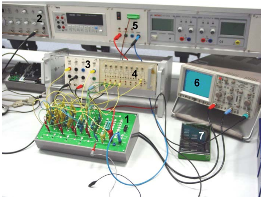
Abb. 1 Der Laborplatz im Überblick. 1 - IC-Trainer 10a; 2 - Funktionsgenerator; 3 - Meßadapter 09b; 4 - Schalterfeld 74; 5 - Festspannungsnetzgerät 08; 6 - Oszilloskop; 7 - Aufbewahrungskasten 10a mit Digitalschaltkreisen.
