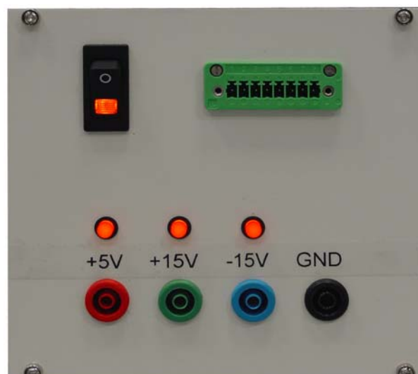
Abb. 13 Festspannungsnetzgerät 08. In der Digitaltechnik werden nur die +5V verwendet.
