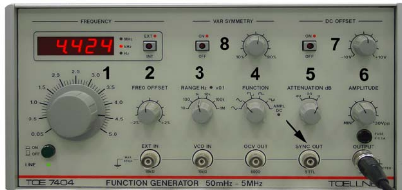
Abb. 1.3 Funktionsgenerator. 1 - Frequenzeinstellung im gewählten Bereich; 2 - Feineinstellung; 3 - Bereichswahl; 4 - Signalform; 6 - Signalabschwächung; 7 - Amplitude; 8 - Gleichpegelüberlagerung (hoch/runter); 9 - unsymmetrischer Signalverlauf (breit/schmal).
