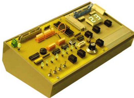
Abb. 5 Die CPLD-Übungstafel 06b. Nur noch wenige steckbare Verbindungen. Rest fest verdrahtet. CPLDs mit 36 oder 72 Zellen.
