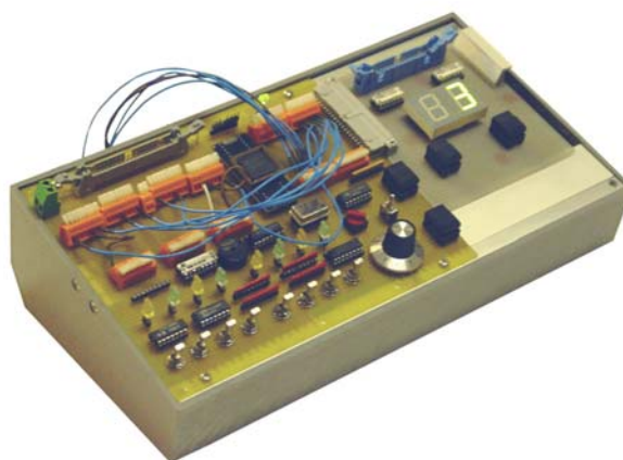
Abb. 4 Die CPLD-Übungstafel 06a. Seitlich ansteckbare Übungsmodule (hier mit Siebensegmentanzeigen). Alle Verbindungen über Draht zu stecken. Constraints-Dateien unnötig. CPLDs mit 36 oder 72 Zellen.
