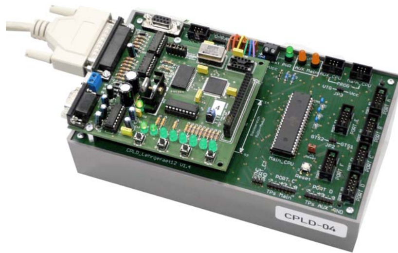
Abb. 19 Das CPLD-Lehrgerät 12. Hier mit dem Pollin CPLD Evaluation Module. Anschluß realer Peripherie über sog. E-A-Ports (die Anschlüsse rechts außen). Unterstützung virtueller Peripherie über zwei eingebaute Mikrocontroller.
