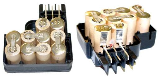
Der gesamte Zellenblock läßt sich einfach herausnehmen. Der Pfeil zeigt auf den Heißleiter (NTC-Widerstand) zur Temperaturüberwachung.
