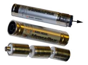
Den Pluspolkontakt wiederverwendbar abbauen (die Schweißpunkte aufbohren). Dann auf die Pluspol-Lötfahne einer der neuen Zellen zentrisch auflöten.
