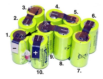
Den Akkublock in die untere Gehäusehälfte einsetzen und die Steckkontakte anlöten. Da die Lötfahnen der Zellen nicht richtig passen, mit Drahtstücken (Pfeile) nachhelfen. Draht nicht zu dünn, denn es fließen Ampere...
