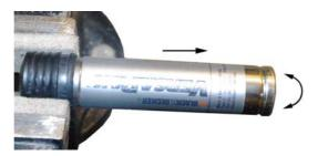
Den Gehäuseboden abschleifen oder abfeilen. Die Zellen können dann herausgezogen werden. Die Isolierröhre (Pappe) auch herausziehen. Die neuen Zellen haben eine eigene Isolation.
