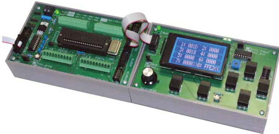
Abb. 6 Die LCD-Bedientafel an einem ATmega-Modul. Drei Ports sind noch frei verfügbar.
