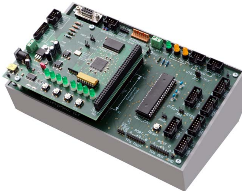
Abb. 1.67 Das CPLD-Lehrgerät 12. Die Plattform (untere Platine) enthält zwei Mikrocontroller, das CPLD-Modul wird aufgesteckt.
