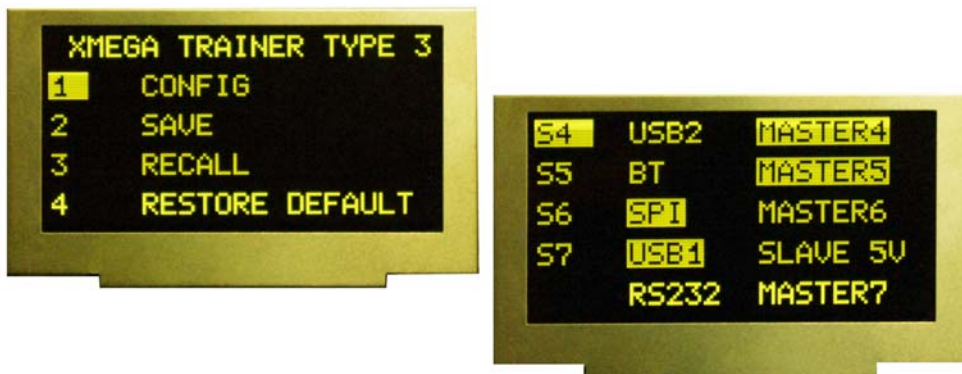
Abb. 1.72 Konfigurationsmenüs, angezeigt auf dem OLED-Display einer Aufsteckplatine. S4 bis S7 sind serielle Schnittstellen, die so konfiguriert werden können, wie es angezeigt ist. Die aktuelle Konfiguration kann im EEPROM gespeichert werden.
