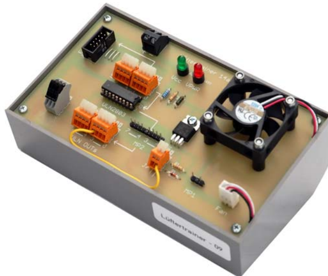
Abb. 1.11 Der Lüftertrainer 14a. Zum Üben braucht man einen Gleichstrommotor, der nicht viel kostet und sich ohne besonderen Aufwand montieren lässt. Lüfter für PCs usw. erfüllen diese Anforderung. Schrauben, Muttern und Distanzhülsen genügen. Man muss ihn nicht in der Hand halten oder lose auf den Tisch legen. Über einen 8-Bit-Port können bis zu 8 Ausgänge angesteuert werden. Ausgangsstufe: ULN2803. Der Treibertransistor des Lüfters wird an einen dieser Ausgänge angeschlossen (Drahtbrücke).
