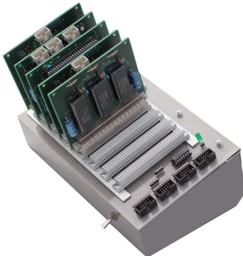
Abb. 1.68 Kleine steckbare Module erlauben es, beliebige Verbundlösungen mit CPLDs und Mikrocontrollern zu verwirklichen.
