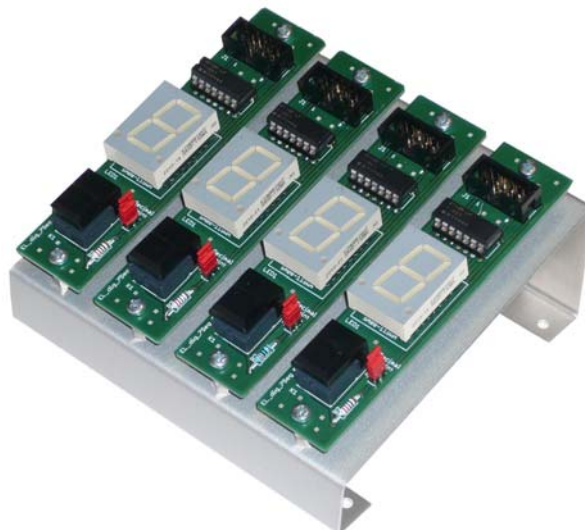
Abb. 1.21 Siebensegmentanzeigen zum Anschließen an 8-Bit-Ports. Sieben Segmente + Dezimalpunkt oder Tastenabfrage (über Jumper wählbar).
