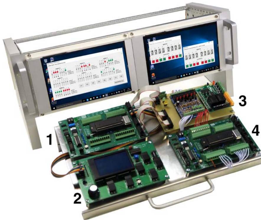
Abb. 1.17 Die grundsätzlichen Komponenten einer Testumgebung oder Prüfplattform.
