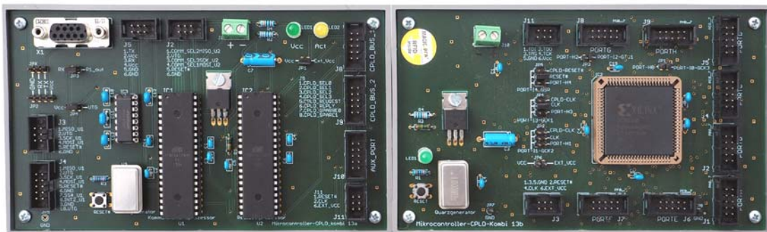
Abb. 1.65 Die Realzeitplattform 13. Links die Mikrocontrollerplatine, rechts die CPLD-Platine. Beide können auch unabhängig voneinander genutzt werden.
