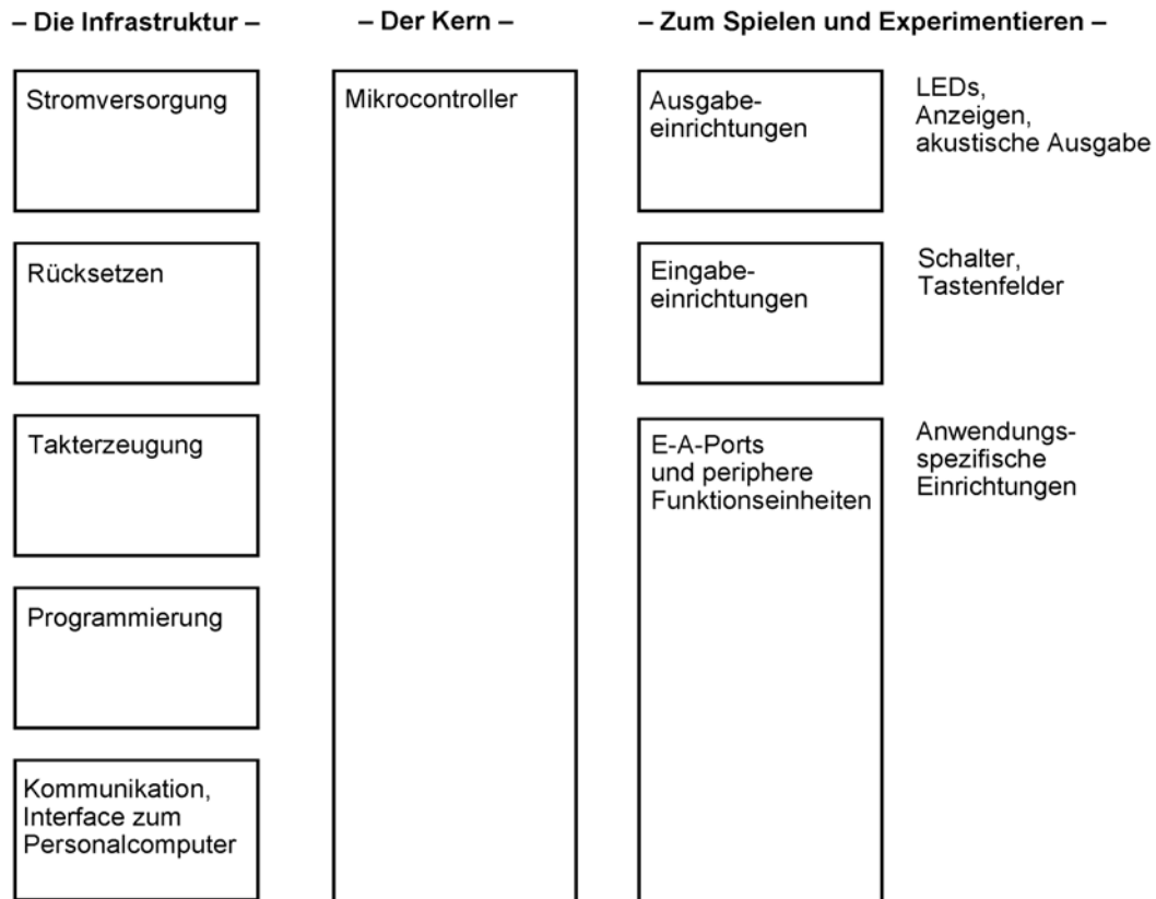
Abb. 1.1 Die meisten Mikrocontrollerplattformen enthalten die Funktionseinheiten, die hier darstellt sind. Die Unterschiede liegen in den Einzelheiten.
