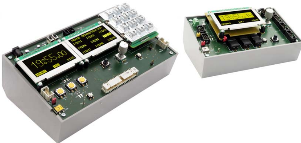
Abb. 1.24 Hier ist alles beieinander: Mikrocontroller, Bedienung, Anzeige, Schnittstellen, universelle Ein- und Ausgabe. Zwei All-in-One-Geräte.
