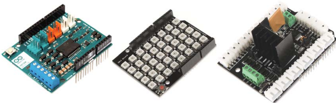
Abb. 1.4 Man fragt sich, was sich die Erfinder wohl dabei gedacht haben... Die Leistungsstufe rechts muss ganz oben sein, allein schon wegen des Kühlkörpers. Aber was ist mit der Leistungsstufe links? Wenn man ein weiteres Modul aufsteckt, kommt man nicht an die Stiftleisten heran. Sinnig ist auch die LED-Matrix in der Mitte. Wenn man noch ein Modul darüberstapelt, wird von den LEDs wohl nicht mehr viel zu sehen sein...
