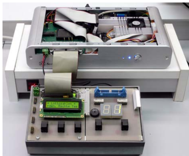
Abb. 1.40 Ein kleiner PC mit einer improvisierten Übungsplattform. Die Peripherie ist als Hardware vorhanden, der Mikrocontroller wird emuliert. Der Peripherieadapter ist in das PC-Gehäuse eingebaut.
