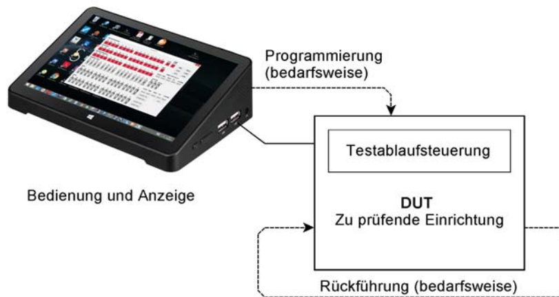
Abb. 1.19 Das Prinzip der Selbstprüfung. Ausgänge sind auf Eingänge zurückgeführt.
